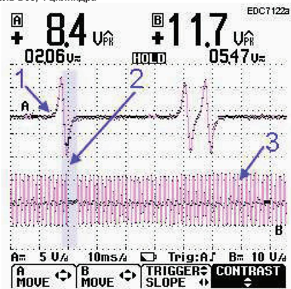
(замеры при  $600\text{мин}^{-1}$  между PIN A73 и A55, датчик частоты вращения коленчатого вала)
